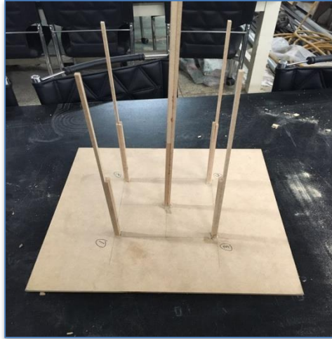
주기동과 댐퍼 기동을 천공하여 시공
